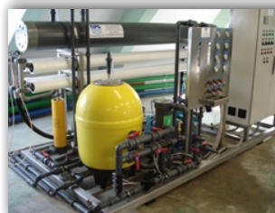
Pozo Izquierdo (Las Palmas - Spain) DESSOL SW38 - 1000 l/h
